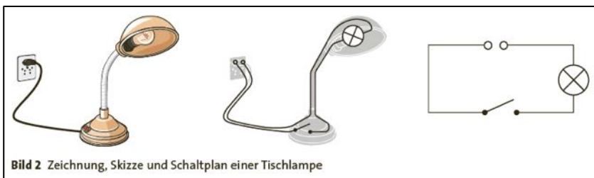
Abbildung 2: Darstellung einer Tischlampe als Zeichnung (gegenständlich), als Skizze (bildlich) und als Schaltplan (symbolisch); Quelle: NaTech 8 Grundlagenbuch, S. 8 (Metzger et al., 2019–2021).
